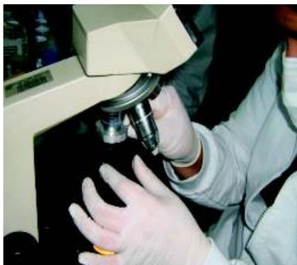
C. Montaje en el porta-objeto de porción del medio de cultivo con dilución después de 24 horas de incubación a temperatura ambiente.
